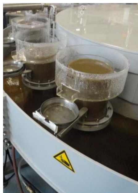
Figuur 8 Moderne, geautomatiseerde apparatuur voor het verwerken van grondstalen op aaltjes
